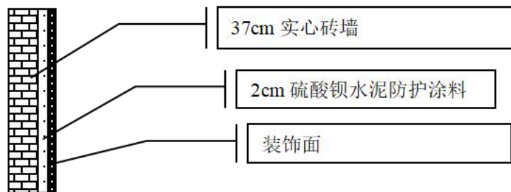
图 1-1 DSA 室（三）东侧墙体屏蔽体材料示意图
